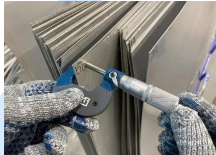
Входной контроль материалов и комплектующих
