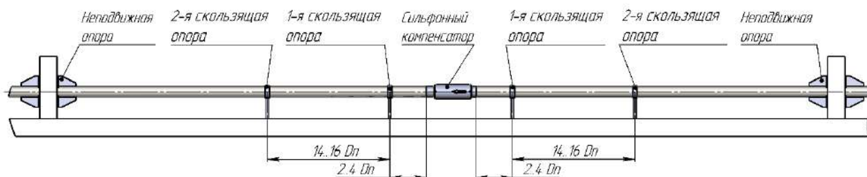
Рис. 17.2 Расстановка подвижных опор при установке компенсатора по середине участка между неподвижными опорами
